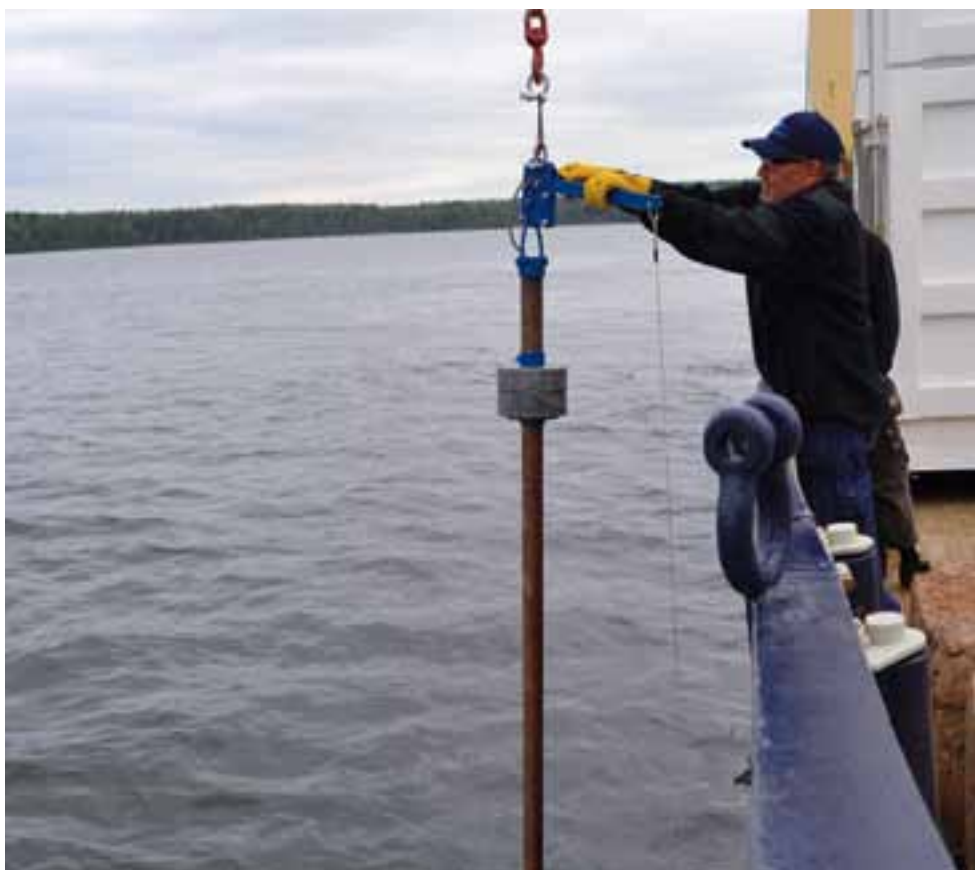
⤴ Den långa kolvlodsprovtagaren förbereds för att ta ett sedimentprov från havsbotten i Stockholms skärgård under fältsäsongen 2014.
